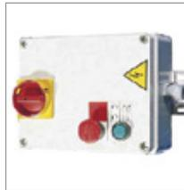
Steuerungsbox geeignet zur Aufputz-Wandmontage mit allen erforderlichen Bedienelementen zur Rampensteuerung inkl. Notastaster inkl. 4 m Verbindungskabel zur Rampe
