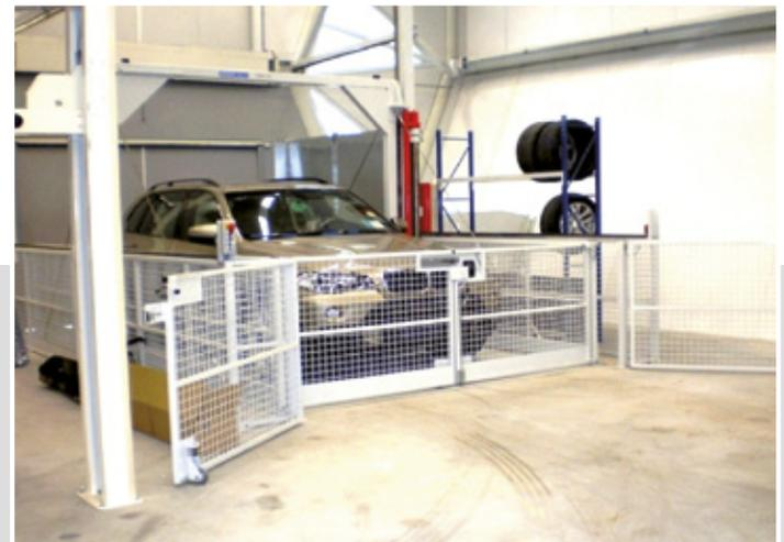
**Autohebebühne als 2-Säulenheber, Nutzlast 2,5 t, Nutzhub 3,64 m**
